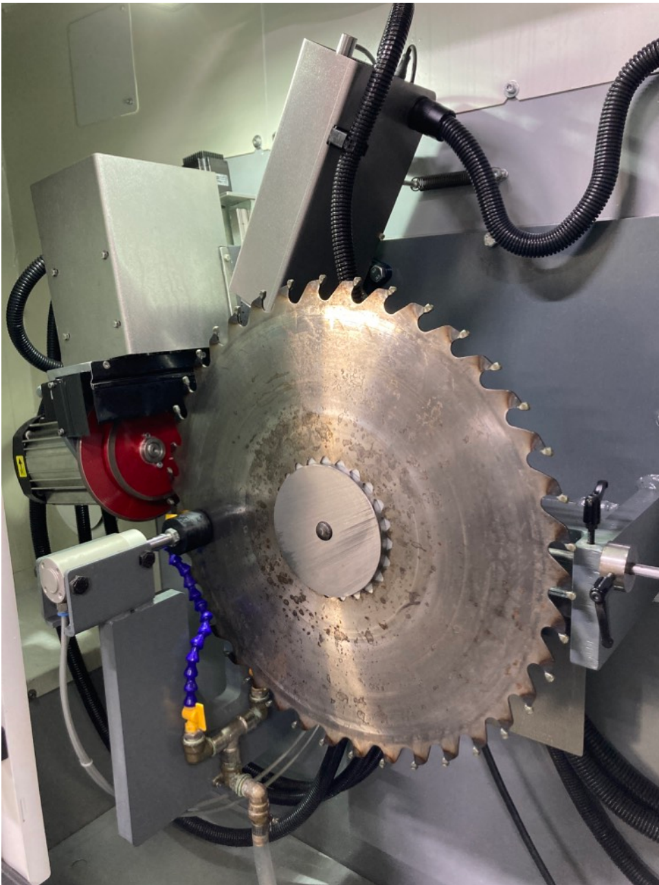
AFILADO CARA EN ÁNGULO GRINDING SHEAR ANGLE
