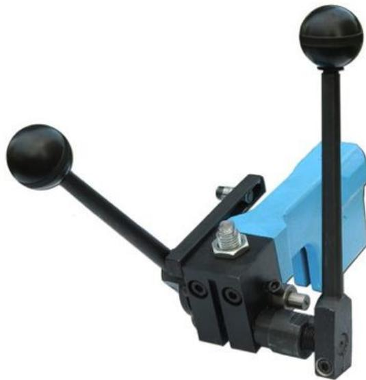
ELITE LM PRO está especialmente diseñado para tensar y endurecer sierras de cinta, liberando así las sierras de deflexiones y deformaciones.
