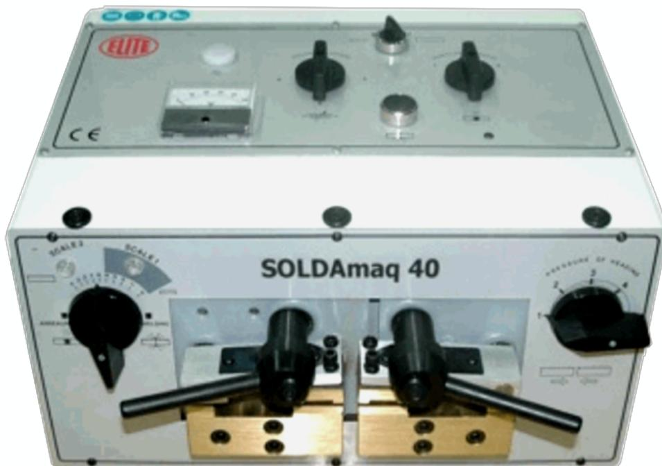
La Elite SOLDAmaq 40 es nuestra sierra de cinta para soldar "Pulsar y listo": simplemente siga los parámetros de soldadura que le proporcionamos según el grosor y ancho de la sierra, cierre las mordazas de sujeción de la sierra y presione el botón de soldadura.
