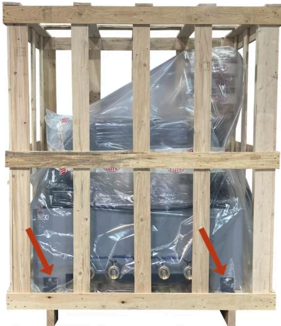
Antes de conectar la máquina, quite las protecciones que la máquina pueda llevar para proteger los componentes durante el transporte.
