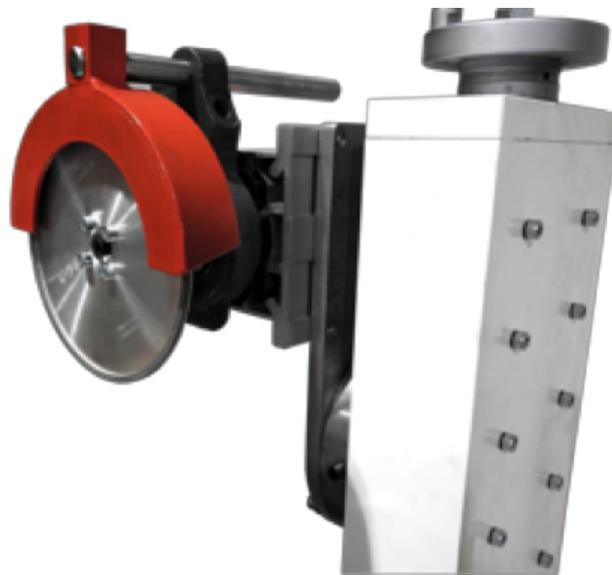
Détail du support de meule avec protection pour meules jusqu'à  $\varnothing 150$  mm. La tête de la meule peut être tournée de  $360^\circ$  par rapport à son axe vertical et de  $90^\circ$  par rapport à l'axe horizontal.
