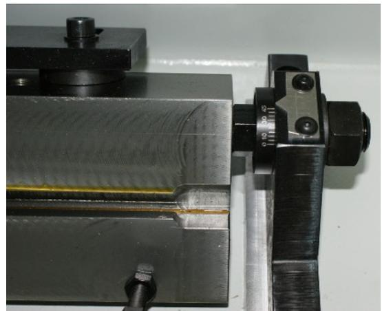
**Image 1: Moteur de meule 1 CV.** Déplacement de la descente de la meule au moyen de guides avec patins de recirculation de billes. Tête montée sur guides linéaires de précision.
