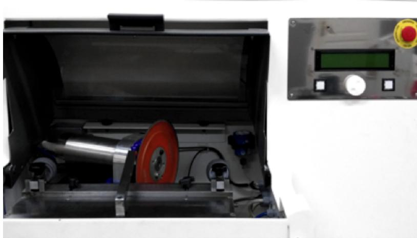
Panneau de commande intégré dans la cabine. Vous pouvez créer et éditer des programmes avec la vue de dessus des dents à affûter, pour un réglage facile.
