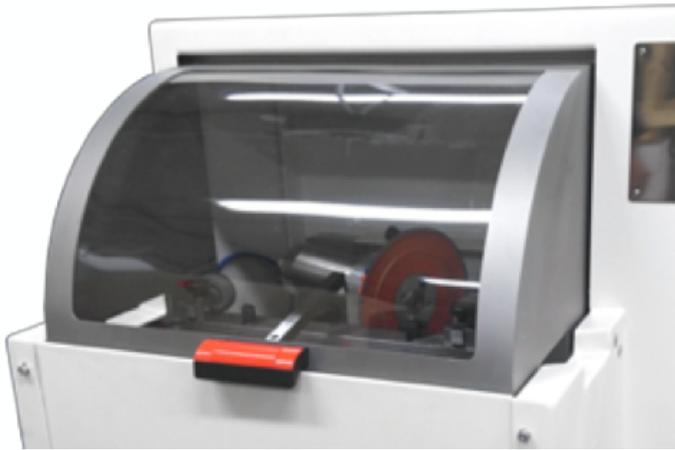
Armoire en acier inoxydable, pour éviter la corrosion qui se produit lors de l'affûtage avec refroidissement.
