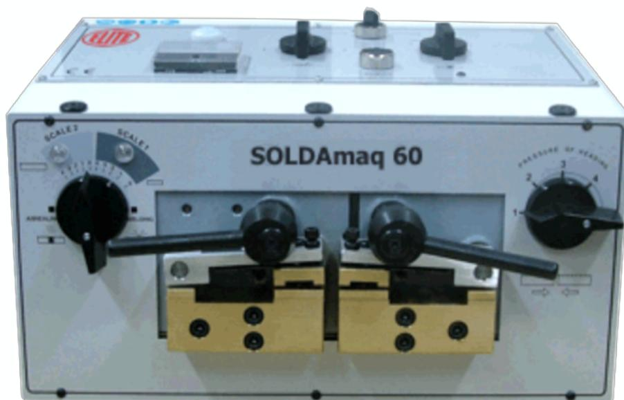
Elite SOLDAmaq 60 est notre scie à ruban de soudage «Push and Go»: suivez simplement les paramètres de soudage que nous fournissons en fonction de l'épaisseur et de la largeur de la scie, fermez les mâchoires de serrage de la scie et appuyez sur le bouton de soudage.
