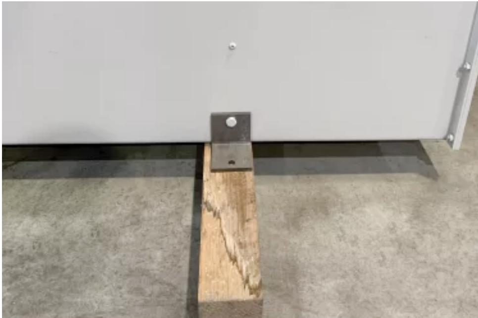
Une fois l'angle de transport retiré, remettez le boulon hexagonal M12 en place et serrez-le.
