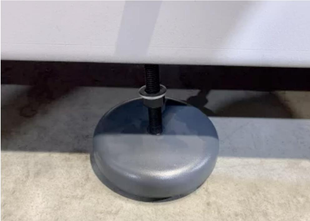
Serrez maintenant l'écrou M12 dans la position nécessaire pour libérer le bois et le chariot élévateur.
