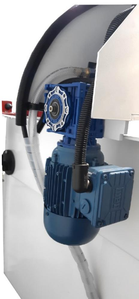
**Carro de afilado** accionado por un motor con reduktor de tornillo sinfín y una rueda de arrastre con recubrimiento de goma para evitar la transmisión de vibraciones durante el ciclo de afilado.
