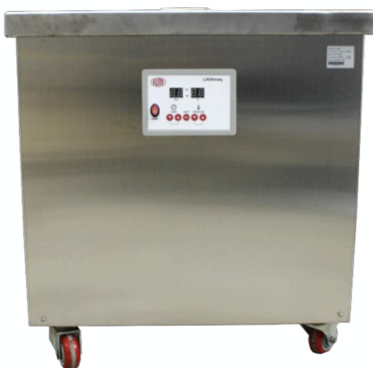
L'Elite LAVAmag 60 prevede un sistema di pulizia degli attrezzi che è il sistema di lavaggio più aggressivo e quindi anche quello che pulisce al meglio. I dischi o gli attrezzi sono completamente immersi nella vasca e si attiva il ciclo di lavaggio, che consiste in temperatura dell'acqua (circa 60 ° C) e vibrazione ultrasonica.
