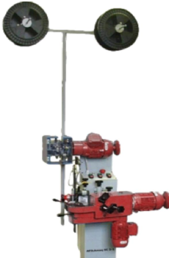
O modelo ELITE SC 2 é o nosso afiador de serras de fita para perfis de dentes triangulares e triangulares espaçados que também podem afiar lâminas de serras circulares de aço de 110-600 mm.
