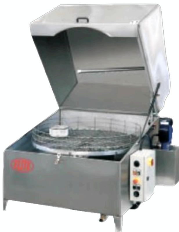
O Elite LAVAmag 1150 oferece um sistema de limpeza de ferramentas que poupará muito tempo ao operador. Insira ferramentas sujas como serras circulares, brocas ou rebarbas na máquina e em 10-15 minutos elas estarão completamente limpas, secas e protegidas contra corrosão.
