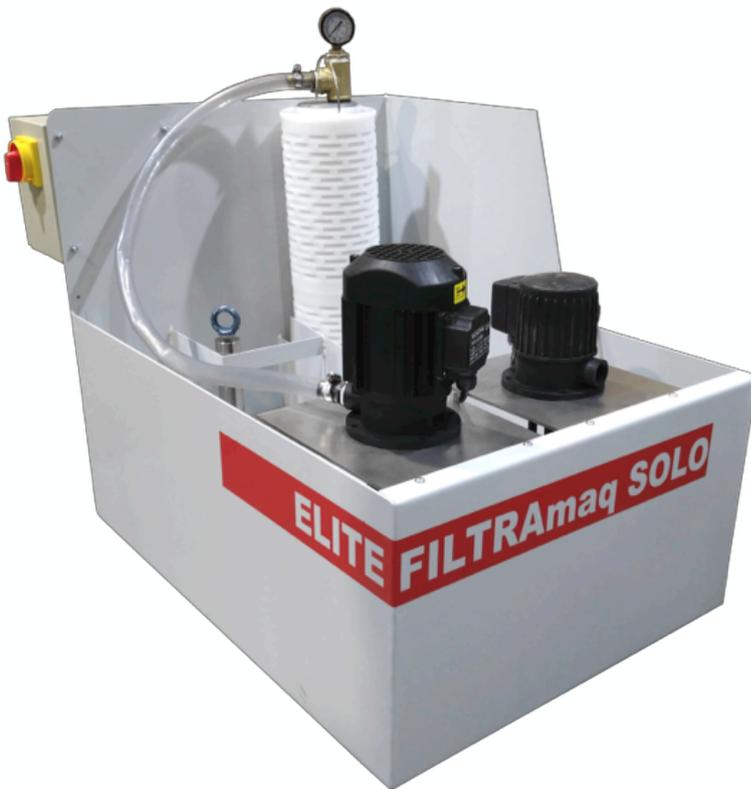
Sistema opcional con bomba de filtrado y bomba de refrigerante ya filtrado
